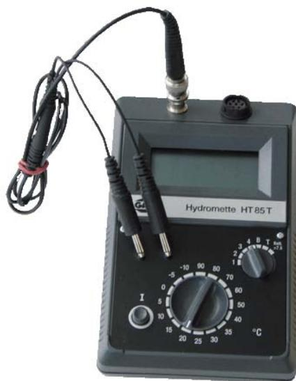
Игольчатый влагомер оснащен 4 позициями корректировки пород древесины с температурной компенсацией измеряемой древесины. Спектр измерений влажности древесины от 4 до 100 %, строительных материалов от 0,5 до 25 весовых % и от 0,5 до 12 объемных % и температуры от -10 до 90 °С. Прибор предназначен для предприятий имеющих сушильные камеры, столярных мастерских, деревообрабатывающих фабрик и комбинатов, продавцов пиломатериалов и др..
