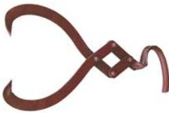
**Клещи для погрузки и трелевки**
