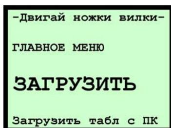
Соедините последовательный кабель между калибром и последовательным портом ПК. Нажимая ENTER калибр спрашивает, в какой блок программы передается таблица developer.
