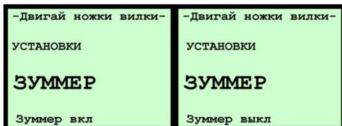
**ЗУММЕР** изменение состояния зуммера ВКЛ/ВЫКЛ нажатием ENTER.
