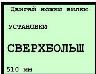
**СВЕРХБОЛЬШ** – максимальный диаметр, который можно измерить калибром. Обычно данная величина устанавливается несколько миллиметров меньше фактического максимального диаметра. Если измеряемый диаметр больше установленного, зуммер даст предупредительный сигнал и на экране калибра появится: 2000 мм. В данном случае нужно измерить окружность лентой и ввести данную величину в мм ПЕРЕКЛЮЧАТЕЛЕМ или с клавиатуры. Калибр вычисляет диаметр с данной введенной величины.
