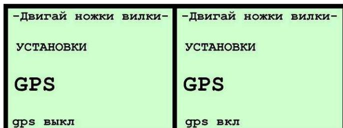
Модуль **GPS** включается и выключается в данном меню. При выборе ВКЛ программа контролирует расход питания и включает модуль при необходимости.
