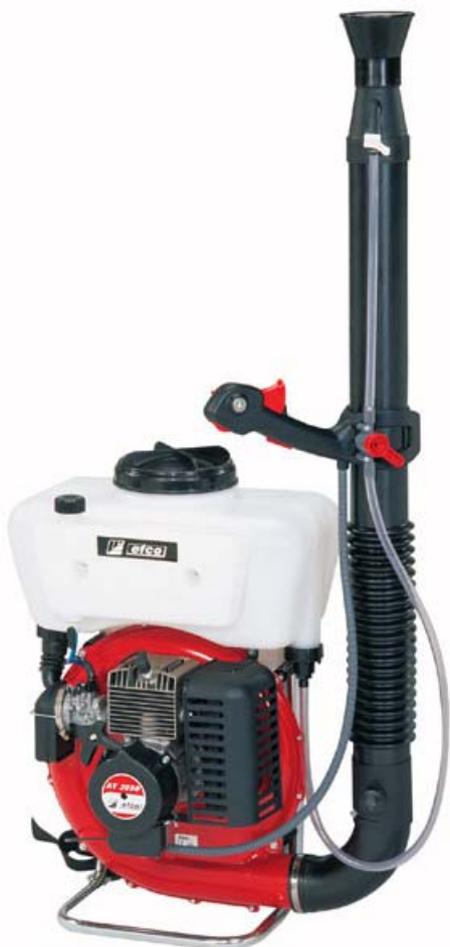
Эффективное и удобное распыление. Скорость потока жидкости регулируется 4х-позиционным вентилем. Динамическая балансировка вентилятора понижает вибрацию. Бумажный фильтр увеличенных размеров обеспечивает максимальную защиту двигателя
