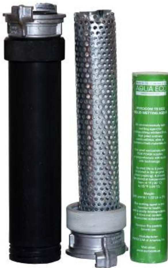
Внутри тубус - смесителя вкладывается перфорированный металлический цилиндр спец. конструкции, в который вставляется твердый смачиватель. Время замены картриджа - около 15 секунд. Смачиватель Rygosom TS ECO или Ливень ТС растворяется в результате омывания струей воды, проходящей под напором через тубус-смеситель.
