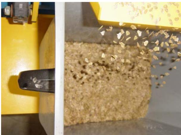
Установка предназначена для бережного обескрыливания семян хвойных деревьев методом влажного трения. Процесс осуществляется в цилиндрическом барабане с приводом от вариационного двигателя. Барабан с приводом опускается и поднимается при помощи электроподъемного устройства.
